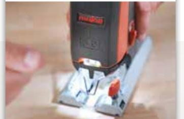
Due LED di alta qualità assicurano la migliore visibilità sul materiale da tagliare. Per evitare di rimanere abbagliati, quando si taglia al di sotto del materiale la luce si spegne automaticamente. Quando la PS 2-18 viene utilizzato nuovamente al sopra del materiale da tagliare, lo Smart-Light si riaccende. Una tripla pressione sulla parte anteriore di PS 2-18 può invertire la modalità di illuminazione. Tutto studiato nei minimi particolari.
