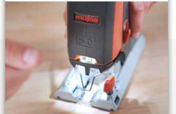
Zwei hochwertige LEDs sorgen für beste Sicht aufs Werkstück. Um Blendung beim Sägen unter dem Werkstück zu vermeiden schaltet sich das Licht aus. Wird die Maschine wieder auf dem Tisch verwendet, schaltet sich das Smart-Light wieder ein. Über dreimaliges Klopfen auf die Front der Maschine, kann der Lichtmodus umgekehrt werden.
