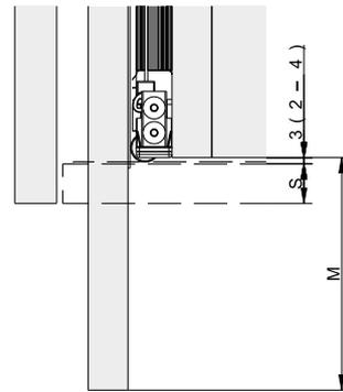
**Beschlag zum Drehen und seitlich Einschieben von Holztüren bis 25 kg. Einheitliche, flächenbündige Frontgestaltung mit gleichmässigem Fugenbild. Pull-Version mit Griff und integriertem Dämpfeinzug.**
