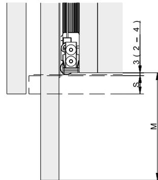
**Beschlag zum Drehen und seitlich Einschieben von Holztüren bis 35 kg. Einheitliche, flächenbündige Frontgestaltung mit gleichmässigem Fugenbild. Push-to-open Funktion für grifflose Schrank-Konstruktionen.**
