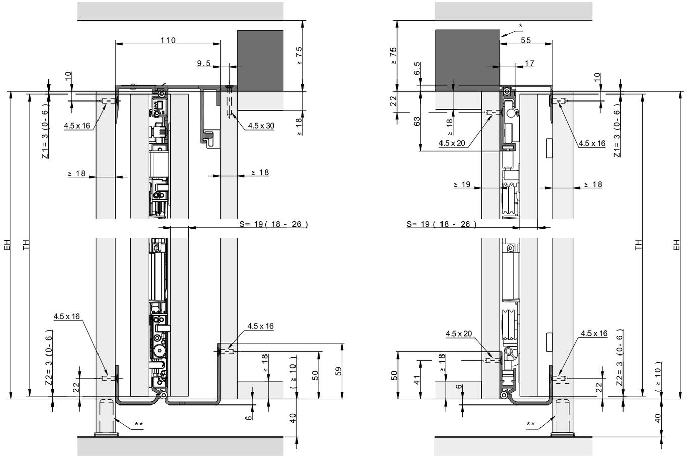
\* Verstärkungsprofil bei 3- und 4-türigen Anlagen ohne Mittelwände
