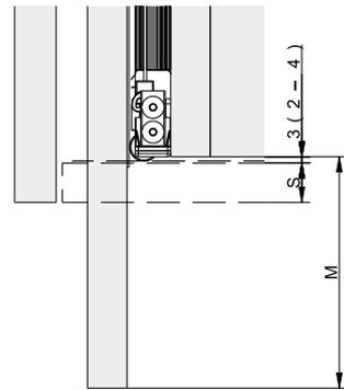
**Beschlag zum Drehen, Falten und seitlich Einschieben von Holztüren bis 20 kg.
