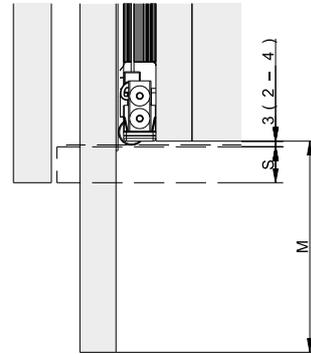
**Beschlag zum Drehen und seitlich Einschieben von Holztüren bis 35 kg. Einheitliche, flächenbündige Frontgestaltung mit gleichmässigem Fugenbild. Pull-Version mit Griff und integriertem Dämpfeinzug.**
