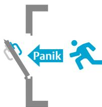
Bei der Panikfunktion B ist die Tür auf der Außenseite mit einem Drücker und auf der Panikseite innen mit einem Drücker bzw. einer Panik-Griffstange/Druckstange ausgestattet. In Fluchrichtung ist die Tür ständig begehbar. Der Drücker entgegen der Fluchrichtung kann, je nach Bedarf, über den Profilzylinder dauernd ein- bzw. ausgekuppelt werden. Diese Lösung eignet sich besonders für Türen, die zeitweise einen Durchgang von außen nach innen über den Drücker ermöglichen sollen.
