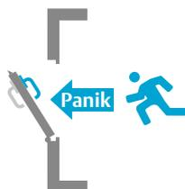
Bei der Panikfunktion B ist die Tür auf der Außenseite mit einem Drücker und auf der Panikseite innen mit einem Drücker bzw. einer Panik-Griffstange/Druckstange ausgestattet. In Fluchrichtung ist die Tür ständig begehbar. Der Drücker entgegen der Fluchrichtung kann, je nach Bedarf, über den Profilzylinder dauernd ein- bzw. ausgekuppelt werden. Diese Lösung eignet sich besonders für Türen, die zeitweise einen Durchgang von außen nach innen über den Drücker ermöglichen sollen.
