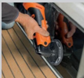
Schleifblätter mit Schaumstoff-Kaschierung zum Entfernen von Kratzern aus z. B. Acryl und Polycarbonat.
