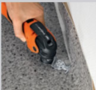
Zum Schneiden von Teppich, PVC-Boden, Karton, Bitumenschindeln und Dachpappe. Mit drei Schneidflächen.
