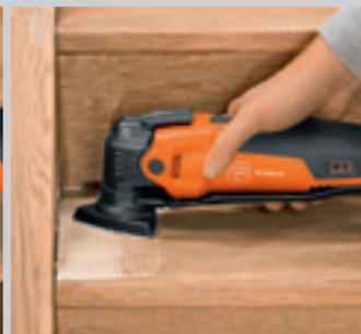
Schleifen an Ecken und Kanten ohne Rückschlageffekte.
